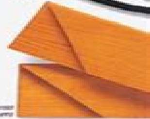
Double slipper (corner peg)
