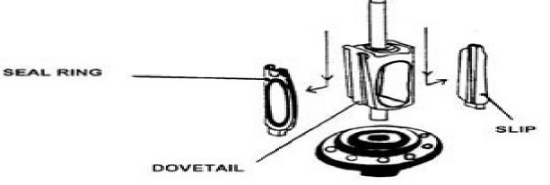
TAPERED PLUG PUSHES SLIPS OUT TO MAKE A TIGHT SEAL
